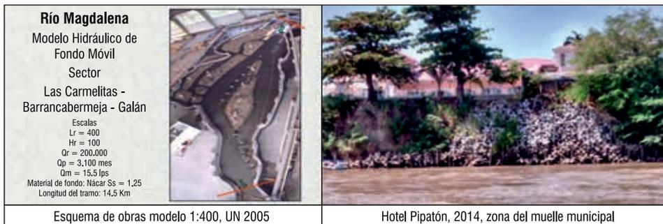
no son obras. El esquema indica que para caudales medios y bajos Barrancabermeja ya no sería puerto fluvial, pero además, durante las avenidas el río podría erosionar las orillas, por encima de los diques, y atacaría las obras, destruyéndolas o sepultándolas.
